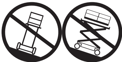
Gevaar voor kantelen Laat het platform niet stijgen op een helling.
