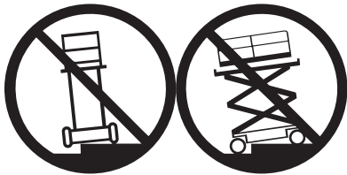
Gevaar voor kantelen Laat het platform niet stijgen op een helling of een traptrede.
