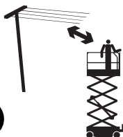
Gevaar voor elektrocutie Deze machine is niet geïsoleerd. Behoud een veilige afstand tot elektrische kabels en apparatuur. U moet rekening houden met het slingeren, stoten en doorbuigen van de machine en slingerende elektrische kabels. Deze machine biedt geen bescherming tegen contact met of de nabijheid van een elektrisch geladen geleider. U moet vrije ruimte behouden tussen een deel van de machine of de lading en elektrische apparaten. Volg de lokale regelgeving inzake elektriciteitskabels. Dood of ernstig letsel is het gevolg van contact of onvoldoende vrije ruimte.
